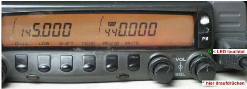
Das zweite Band mit der rechten Funktionstaste anwählen.
